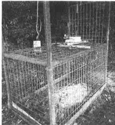
センサーやシリンダーは箱わなに簡単に取り付けられる
